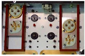
ソケット位置をマイクロスイッチで検出し、バイアスも連動で 切換えます。
