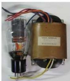
DC-DCに使用したトランス サイズ比較の為300B
