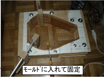
ハロゲンランプ入りパイプにてサイドの曲げ
