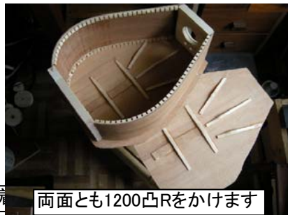
予め荒切り・ブレイシングをした面板接着
