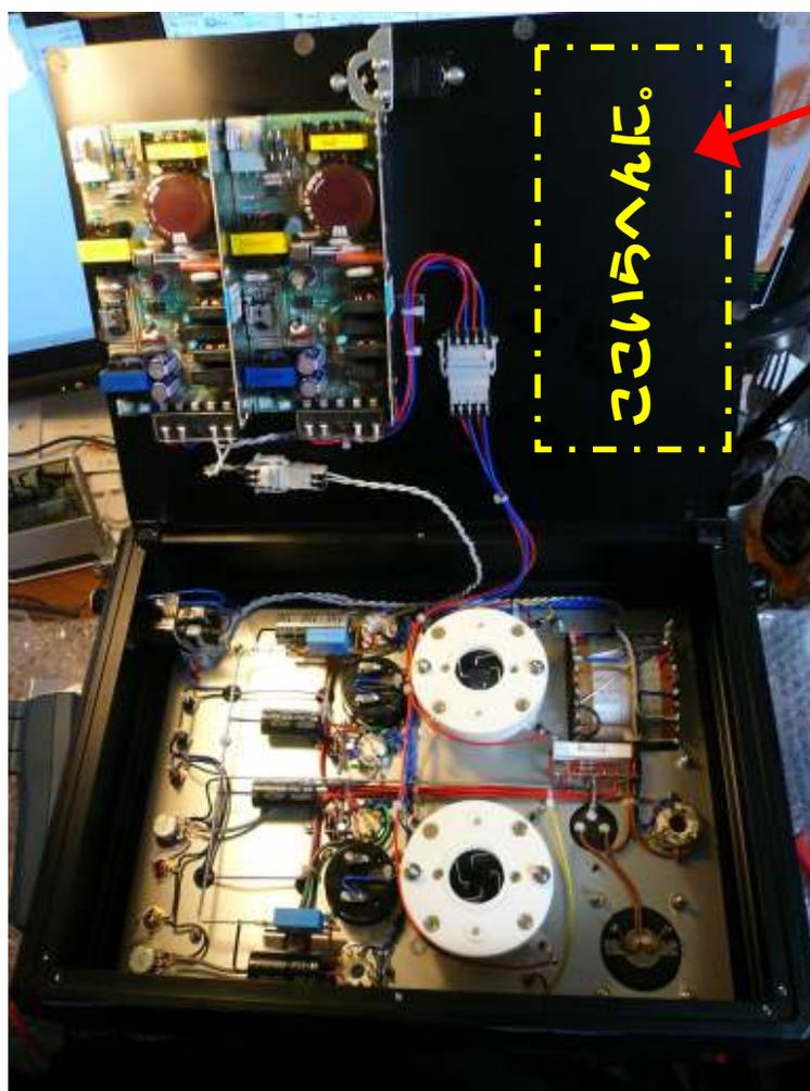
→中身。終段管の805はスイッチング電源から給電します。
