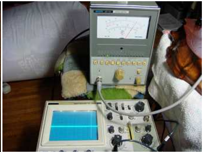
通電、ノイズ測定中、0.025mv(RMS)で優秀な成績 ケースなしで心配していたが発振も無く、一安心。
