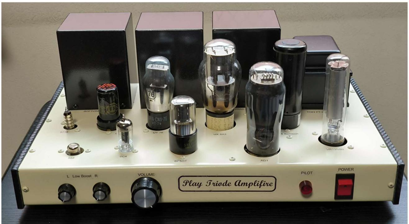
原設計の思想に従い、入力段から出力段にかけて真空管のサイズを大きくしています。また、前後の真空管もスタガーに配置して、後ろ側に配置している真空管も前からよく見えるように配慮しています。
